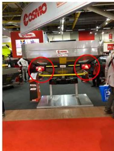
幅が規定を超えていなくてもトラクタの灯火が隠れる場合には灯火類が装備されています。
