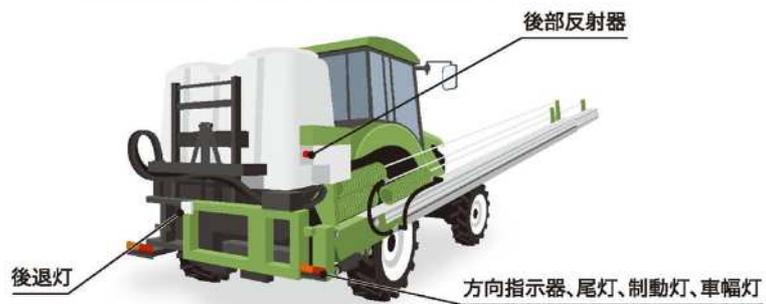
灯火器が隠れる場合は方向指示器や尾灯，ブレーキランプ，車幅灯，後退灯などを作業機に新たに付ける必要があります。
