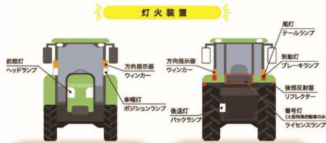
まず、図に見えるようにトラクタの灯火器類は乗用車と同様なものが取り付けられており、それぞれについて保安適合基準が定められています。
